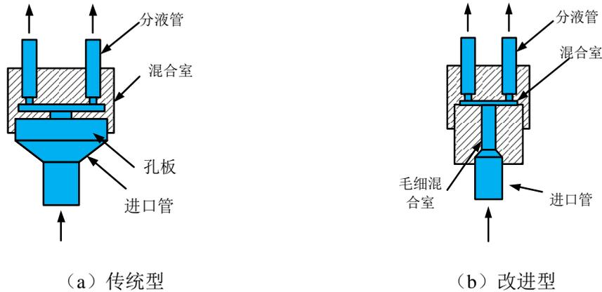
图 1-20 压降型分流器示意图
